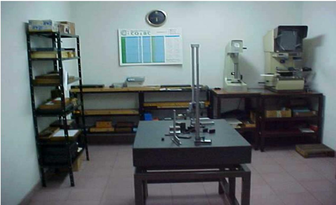
Disponemos de todo tipo de instrumentos de calibración como son calibres , micrómetros proyector de perfiles, durometro,etc.....:
